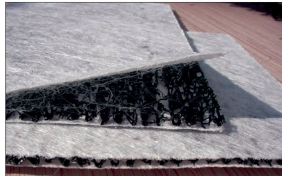
Figure 7.8 – Exemples d'applications d'une couche de protection composée d'une membrane nopée drainante et d'une membrane de filtration
