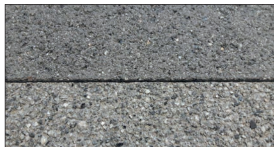
Figure 5.9 – Différences entre une surface en béton grenillée (en haut) et dénudée (en bas)
