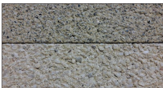
Figure 5.6 – Exemple de surface en béton dénudée grossière (avec du quartz 2-4 mm) et fine (avec du granite 1-2 mm)
