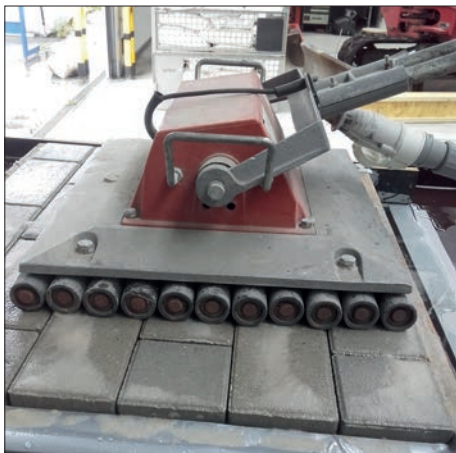
Figure 4.4 – Appareil ultrasonique à rouleaux pour le compactage de la couche de pose pour dalles classiques (de plus petite taille)
