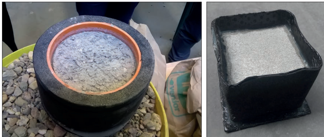
Figure 6.3 – Epreuves pour déterminer la résistance au gel/dégel en présence de sels de déverglage selon l'Annexe D de la NBN EN 1339
